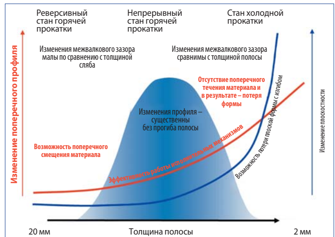
Рис. 5. Переходные значения выпуклости поперечного профиля и планшетности, вызванные изменениями по ширине полосы
