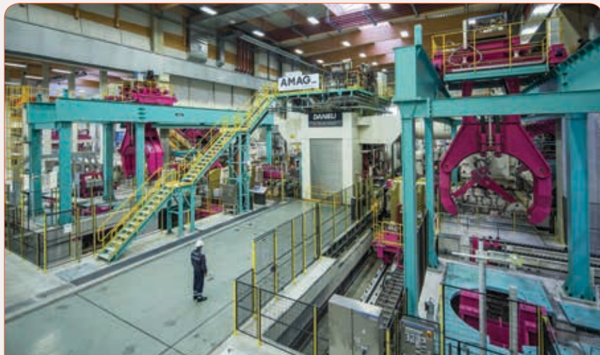
AMAG轧制公司所使用的达涅利创新性双卷热轧机
