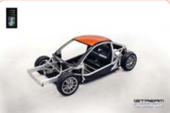
使用挤压铝管的iStream Superlight ®一体式车架
