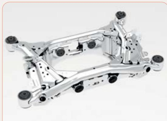
捷豹I-Pace电动车后底盘由铝挤压件、液压成形管和冲压件通过熔焊制成。
