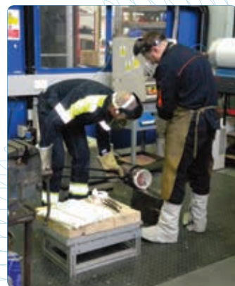
Richard Keyte和他的同事正在将融化的金属浇入叠箱铸模中 (book mould)。
